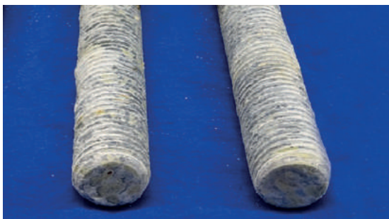
HMR Stabendgewinde nach 480 h Salzsprühnebeltest.
