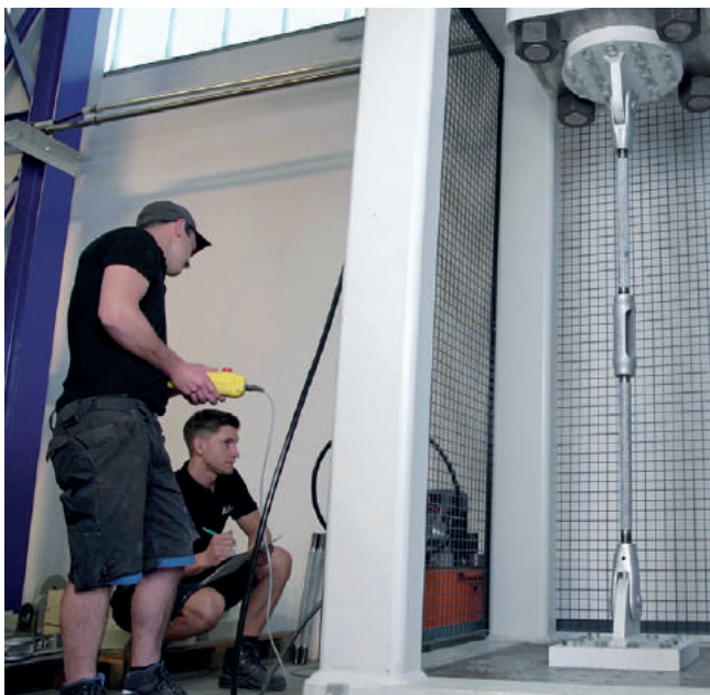
Betriebseigener Zugversuch, ausgeführt durch qualifiziertes Personal.
