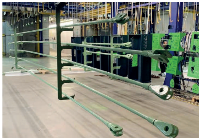
Zugstabsysteme der Gewindegrößen M24-42, pulverbeschichtet im RAL-Farbtönen 6021.
